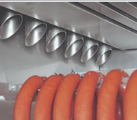
Ausblasdüsen blow-out pipes
